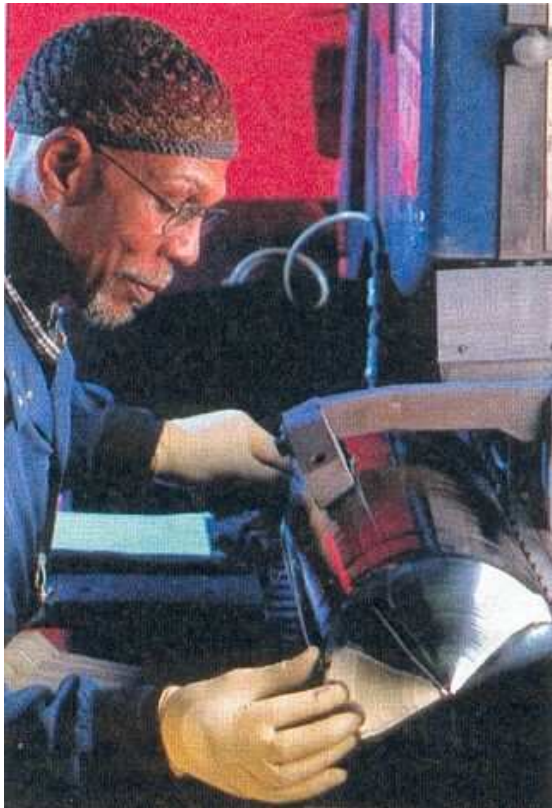
Siliziumrohling wird auf Durchmesser geschliffen
