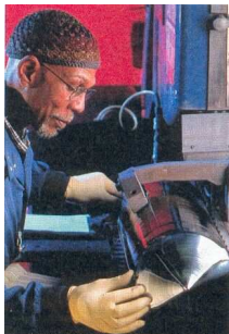
Siliziumrohling wird auf Durchmesser geschliffen
